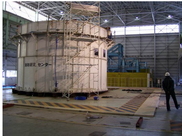
Shaking table untuk menguji kekuatan struktur bangunan bila terjadi gempa.
