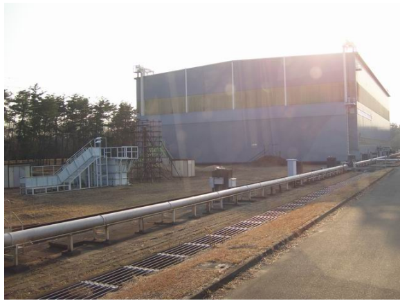
Rainfall simulator ini berada di atas rel sehingga dengan cepat dapat digerakkan beberapa ratus meter untuk eksperimen berbagai jenis topografi, soil dan vegetasi.
